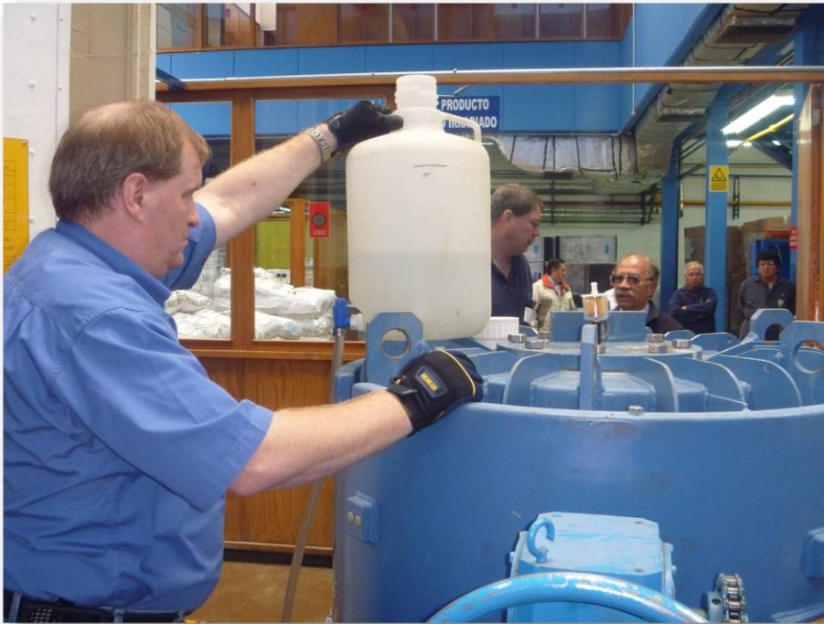
Verificación de hermeticidad de los lápices de cobalto en el contenedor de transporte
